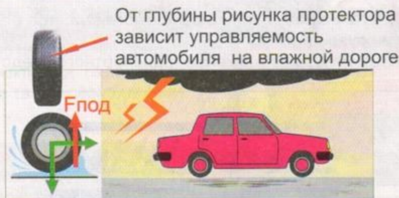
Рис. 6.8. При движении по влажному покрытию с увеличением скорости движения возникает вероятность проявления явления аквапланирования, особенно при износе протектора шин
