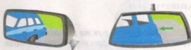
Рис. 4.3.1. Проверка правильности регулировки зеркал
