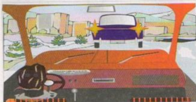
Рис. 9.6. Водитель синего автомобиля лёгким нажатием на педаль тормоза включил фонари стоп-сигналов, предупреждая о намерении снизить скорость или остановиться
