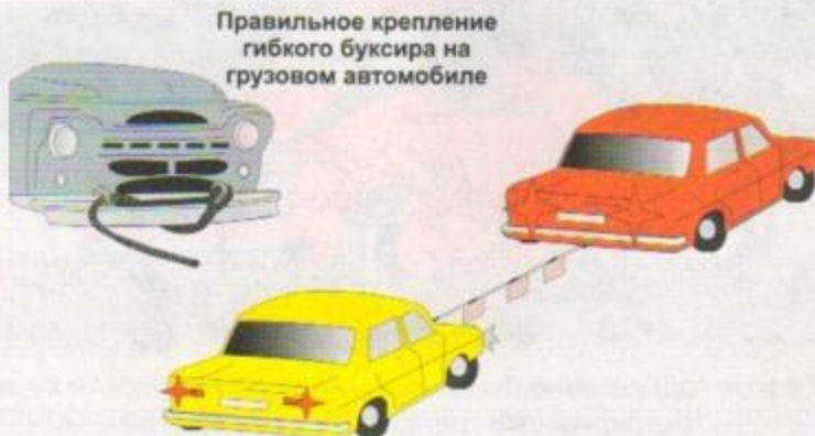
Рис. 14.2.3. Водителю буксировщика следует начинать движение и двигаться плавно без рывков и резких торможений, следить за положением гибкой сцепки (она должна быть натянутой), а также за предупреждающими сигналами буксировщика и не допускать при торможении или остановке образования петли у гибкого буксира
