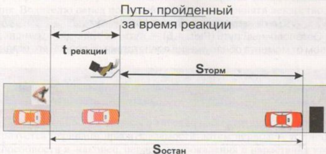
Рис. 1.2. Время реакции — это время, затраченное водителем от момента обнаружения препятствия до момента воздействия на органы управления автомобилем.
