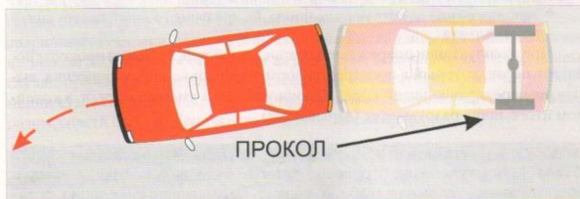
Рис. 19.1. В случае прокола шины, автомобиль начнёт уводить в сторону повреждённой шины
