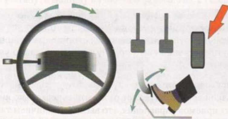
Рис. 18.26. Основные приёмы вывода автомобиля из заноса на скользкой дороге: поворот рулевого колеса в сторону заноса задней части автомобиля и изменение положения педали подачи топлива
