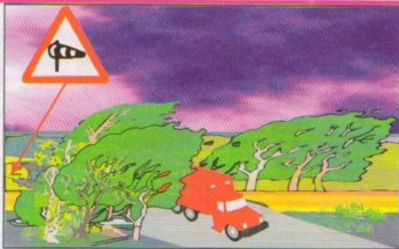
Рис. 18.12. Движение при сильном боковом ветре. На выезде с закрытого участка дороги на открытый водителю следует ожидать сильное влияние бокового ветра на движущийся автомобиль
