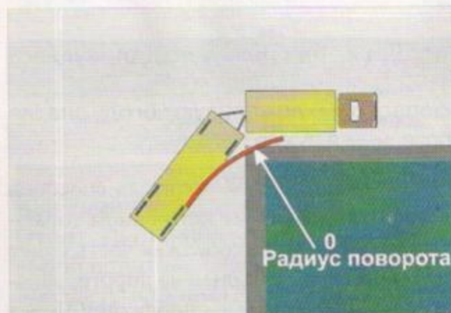
Рис. 8.8. Смещение прицепа на повороте
